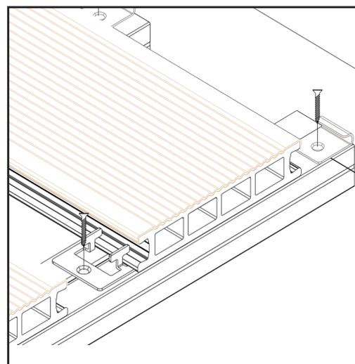
› Pour assurer une bonne ventilation de la structure, une cale plate de 3 mm minimum peut être placée entre chaque lame et les lambourdes (nous préconisons d'utiliser une cale de 5 mm).
